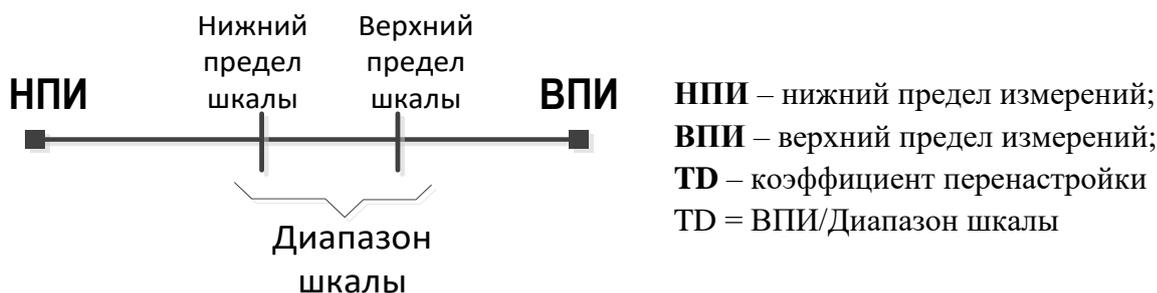
Рисунок 1 – Пределы измерений
