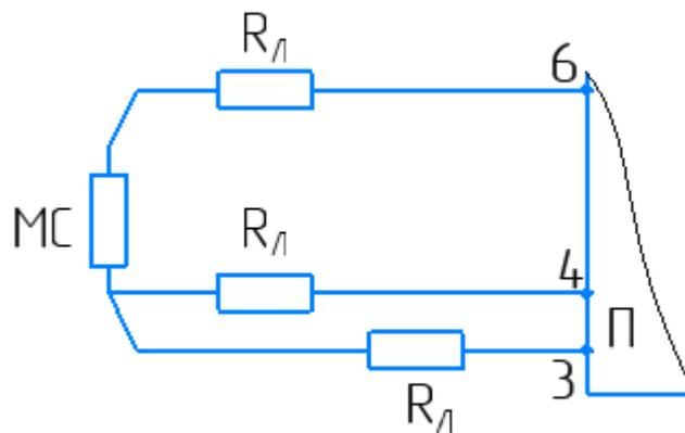
Рисунок В.2 – Схема подключения для проверки функционирования преобразователей, работающих с термопреобразователями сопротивления (трехпроводная схема). Остальное – рисунок В.1
