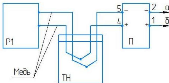
Р1 – компаратор напряжения
