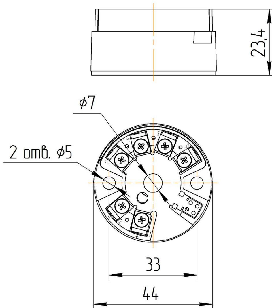
Рисунок 1 – Габаритные размеры
