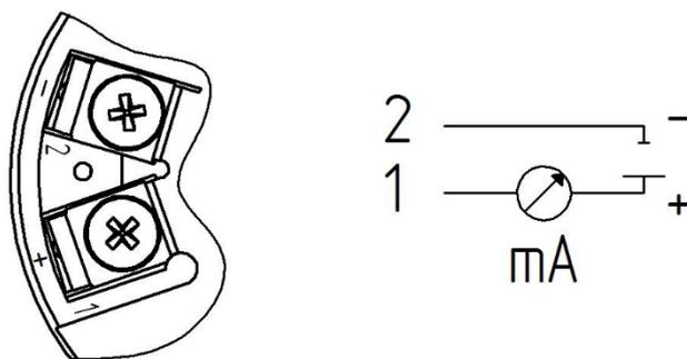
Рисунок 2 – Клеммы для подключения питающего напряжения
