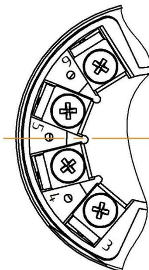
Рисунок 3 – Клеммы для подключения входного сигнала
